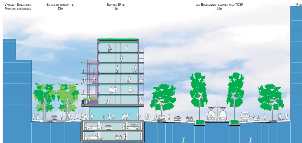
Coupe de principe sur les boulevards reconfigurés issue de l'étude urbaine de Pierre Gangnet (2010)
